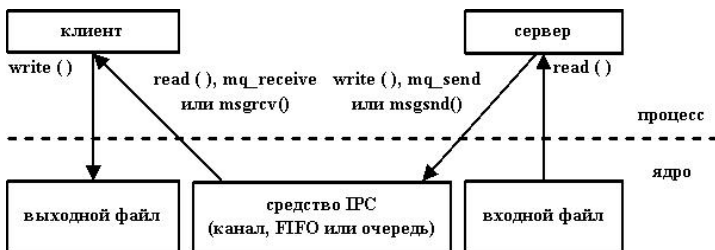
Рис. 3.14. Передача содержимого файла через ядро
